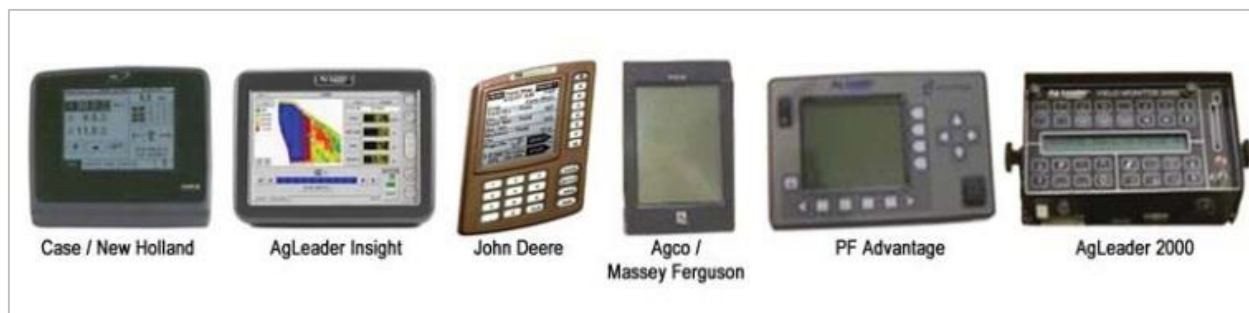
Figura 4. Tipos de monitores de rendimiento más difundidos en la agricultura de precisión. Fuente: Bongiovanni et al. (2006)
