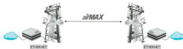
Figura 3 Esquema de un Enlace PTP Fuente: (Gutierrez, 2020)
