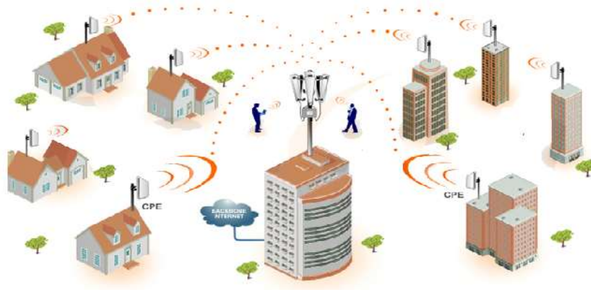
Figura 4 Esquema de Enlace PTMP Fuente: (Lamed)
