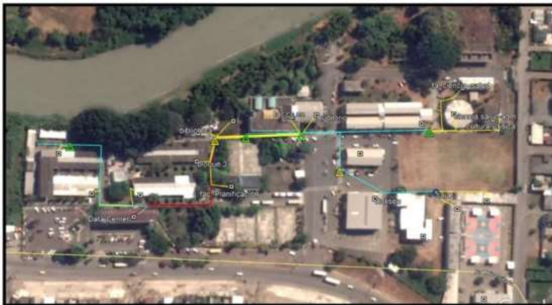
Imagen #1: Despliegue de la nueva red de fibra óptica para el WIFI en el Campus Central foto satelital.
