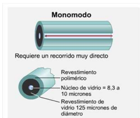
Figura 1. Estructura de la fibra óptica monomodo. Fuente (Digital Azarias, 2016)
