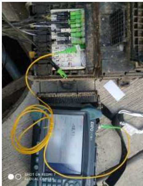
Figura 14. Medición con OTDR. Fuente: Consorcio NPlay
